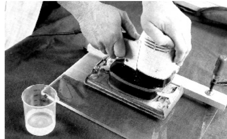
Abb. 11: Mechanisches Mattieren mit Schwingschleifer
