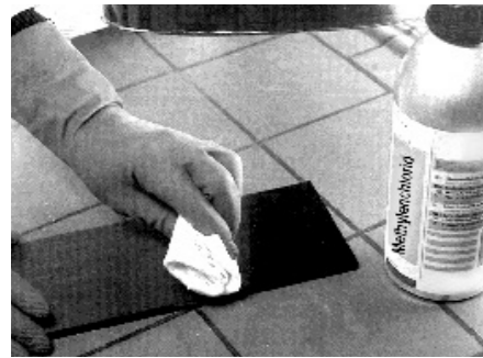
Abb. 13: Chemisches Nachbehandeln einer vorgeschliffenen Oberfläche
